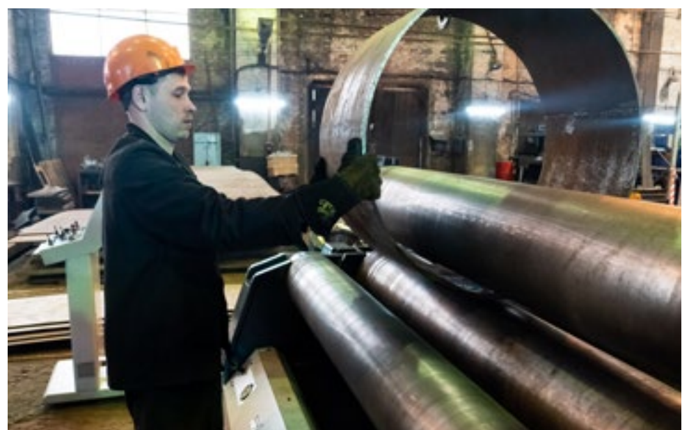
▲ Новое оборудование – весомая помощь при изготовлении цилиндрического оборудования
