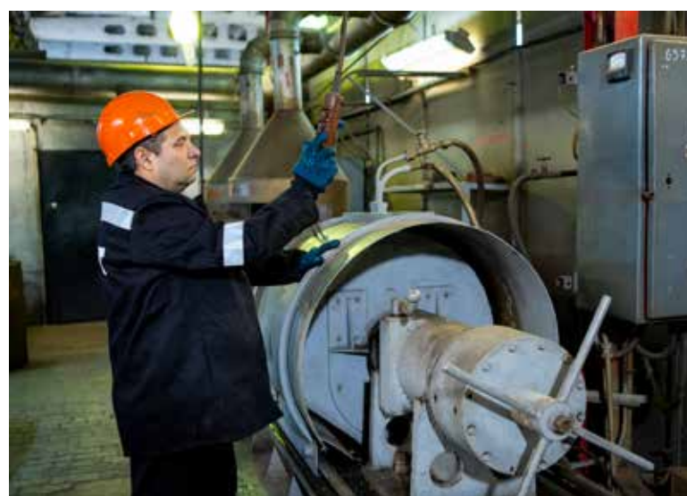
▲ В процессе заливки баббитом на установке главное – опыт, внимательность и сноровка
