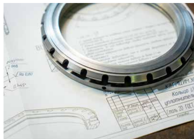
▲ Отработан полный цикл получения уникальных запчастей: от чертежа до готовой детали
