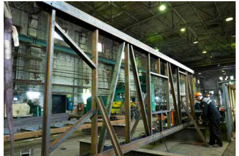
▲ Конструкция вакуум-вытяжки очень большая, её собирают в РМЦ по частям
