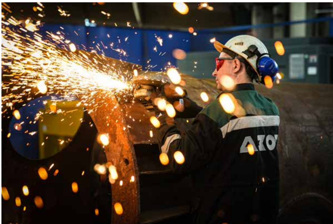
▲ Зачистка ресивера, который будет задействован в системе криогенной очистки
