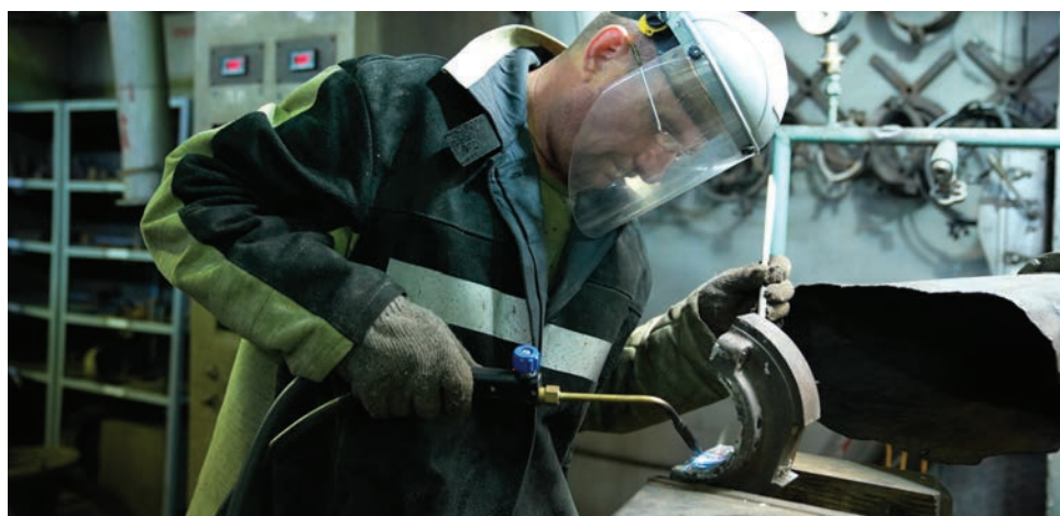
▲ Ремонт подшипников – ювелирная работа, особое направление слесарного дела. Специалисты, умеющие её выполнять, на особом счету
