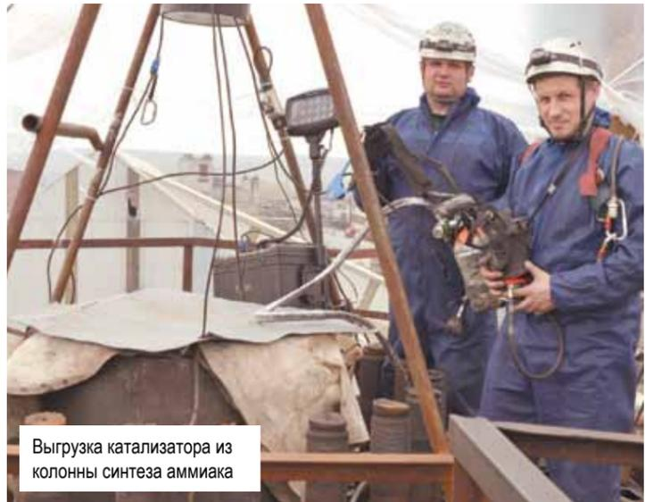
Выгрузка катализатора из колонны синтеза аммиака
